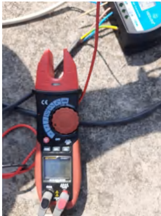
Gambar L.10 Pengukuran tegangan pada baterai sebesar 12,40 V
