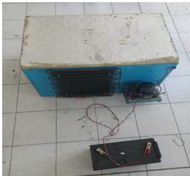
Gambar L.1 Pemasangan rangkaian sistem pendingin
