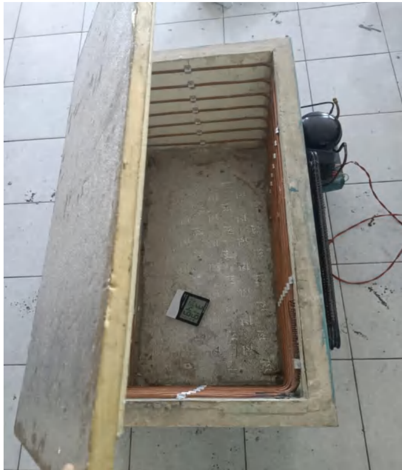
Gambar L.6 Suhu pada system pendingin 31,9°C
