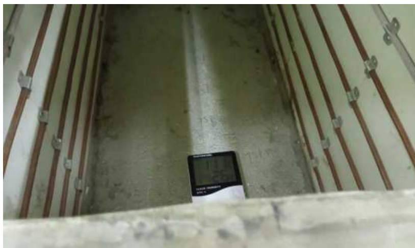
Gambar L.4 Suhu pada system pendingin 11,1°C
