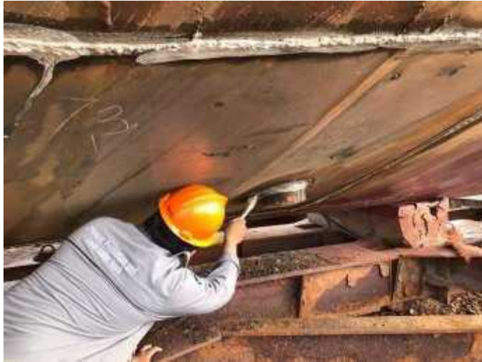
Gambar 10. Welding check menggunakan kapur dan solar Sumber: Data primer, 2023
