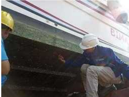
Gambar 3. Proses penyekrapan Sumber: Data primer, 2023
