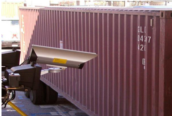
Gambar 2. Proses scan no kontainer oleh OCR
