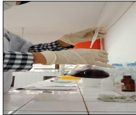
Lampiran 19. Dokumentasi proses pengeringan kertas saring TSS di laboratorium
