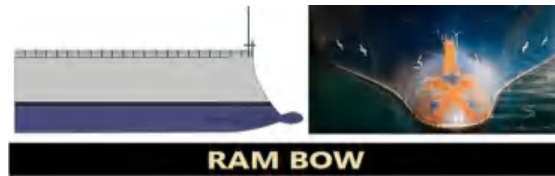
Gambar 11. Haluan Kapal Ram Bow Sumber: Ilmu Kapal dan Logistik, 2023
