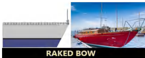
Gambar 7. Haluan Kapal Raked Bow Sumber: Ilmu Kapal dan Logistik, 2023
