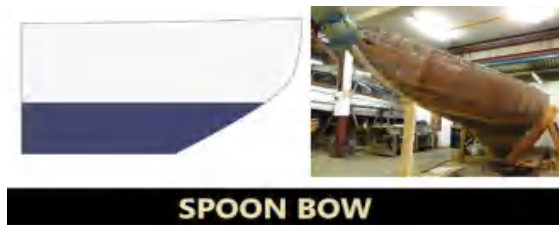
Gambar 9. Haluan Kapal Spoon Bow Sumber: Ilmu Kapal dan Logistik, 2023
