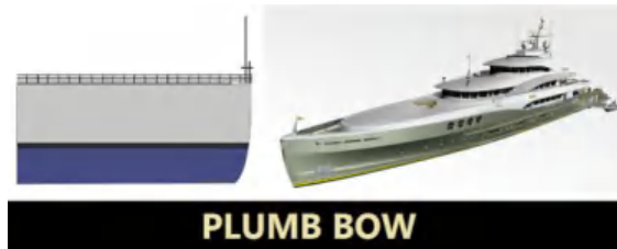
Gambar 6. Haluan Kapal Plumb Bow/Straight Bow Sumber: Ilmu Kapal dan Logistik, 2023
