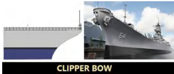
Gambar 8. Haluan Kapal Clipper Bow Sumber: Ilmu Kapal dan Logistik, 2023
