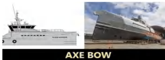
Gambar 12. Haluan Kapal Axe Bow Sumber: Ilmu Kapal dan Logistik, 2023
