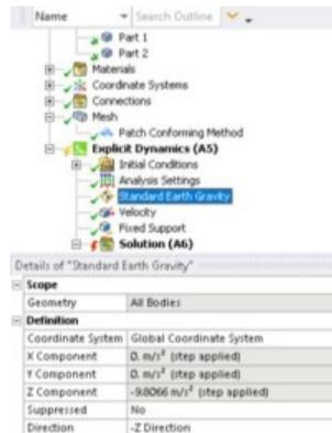
**Gambar 24.** Detail dari Standard Earth Gravity
