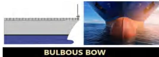
Gambar 9. Haluan kapal bulbous bow Sumber : Ilmu Kapal dan Logistik, 2023
