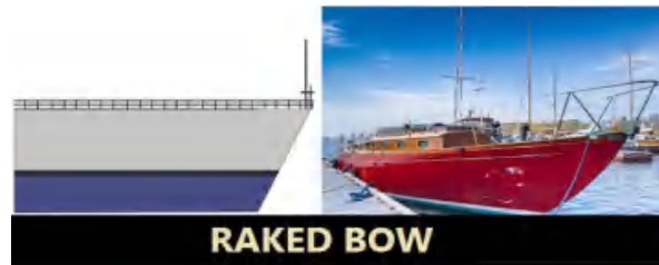
Gambar 6. Haluan kapal raked bow Sumber : Ilmu Kapal dan Logistik, 2023
