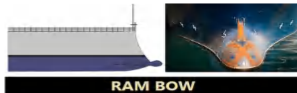
Gambar 10. Haluan kapal ram bow Sumber : Ilmu Kapal dan Logistik, 2023
