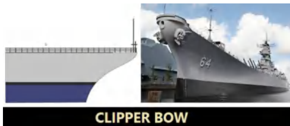
Gambar 7. Haluan Kapal Clipper Bow Sumber : Ilmu Kapal dan Logistik, 2023
