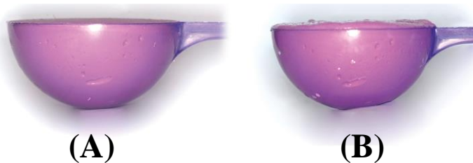
Gambar 2. 4. Demonstrasi imbibisi. (A) Alginat sesaat setelah setting. (B) Perubahan dimensi terlihat setelah penyimpanan 48 jam dalam air.
