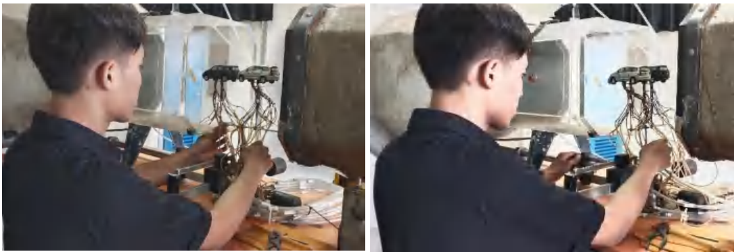
Proses pemasangan model uji pada wind tunnel
