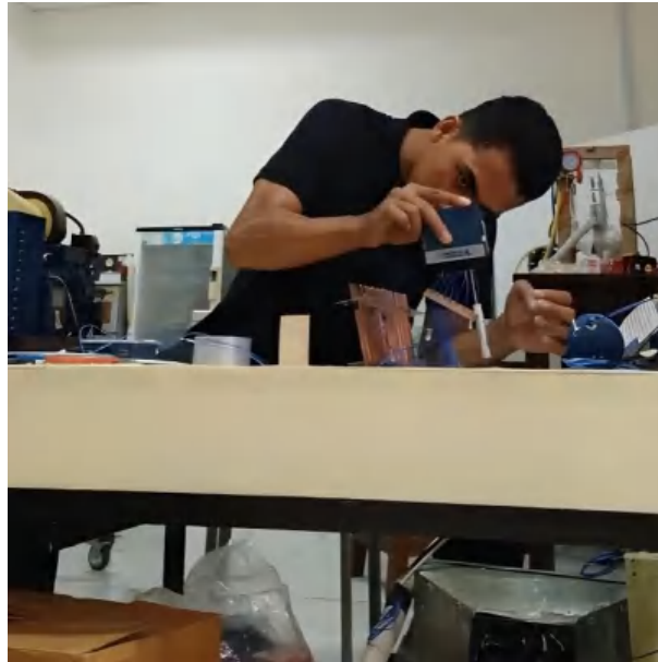
Gambar 47 Pemasangan termokopel pada modul labview
