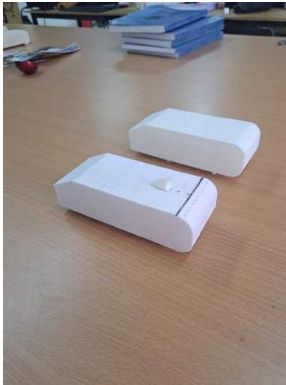
Model uji tanpa dan dengan kontrol pasif aliran
