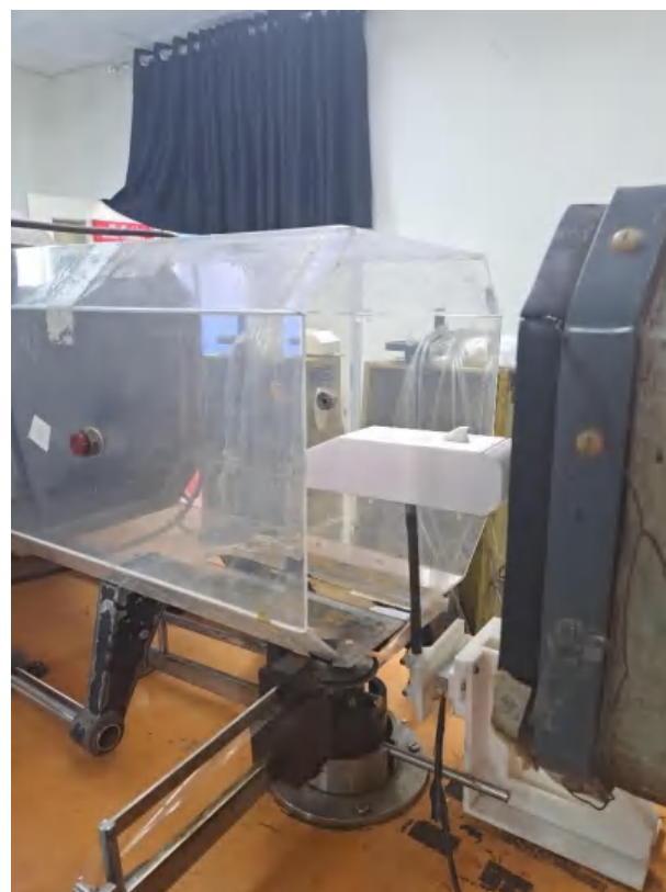
Proses pemasangan model uji ke wind tunnel
