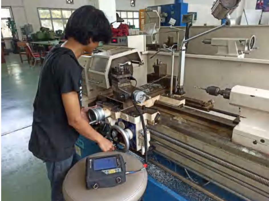
Pembubutan material dan pengambilan data getaran
