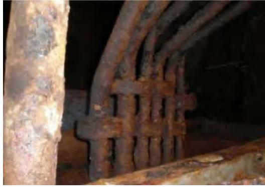
**Gambar 2.6** Korosi seragam pada pipa besi
