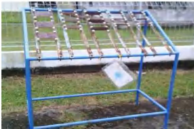
**Gambar 2.1** Spesimen yang diekspos ditempatkan di atas rak pengujian
