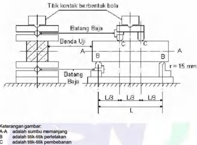
Gambar 2 Susunan benda uji kuat lentur, perletakan dan pembebanan (SNI 4431:2011)
