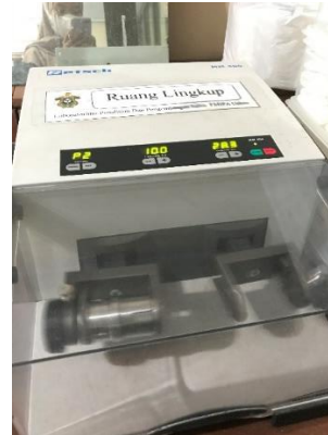
Fe, Cu dan Karbon Hitam di campur menggunakan Retsch MM 400 selama 30 menit frekuensi 10 Hz
