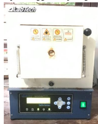
dipanaskan menggunakan furnace selama 12 jam pada suhu 70°C
