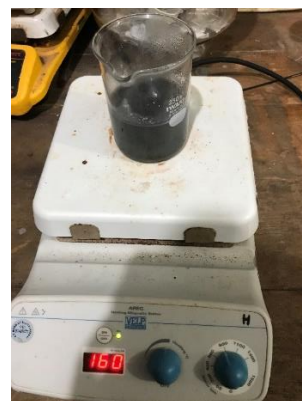
Komposit Selulosa/Fe-Cu/Karbon Hitam/PVA diaduk menggunakan magnetic stirrer pada suhu 160°C 900 rpm hingga menjadi gel.
