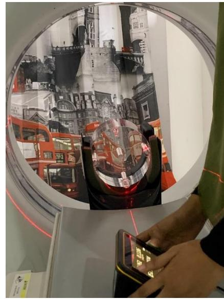
**Lampiran 2:** Penempatan detektor dan multimeter pada *phantom*
