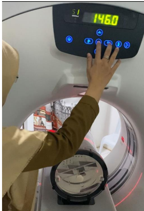
Lampiran 3: Tes phantom dan kalibrasi pesawat CT scan.
