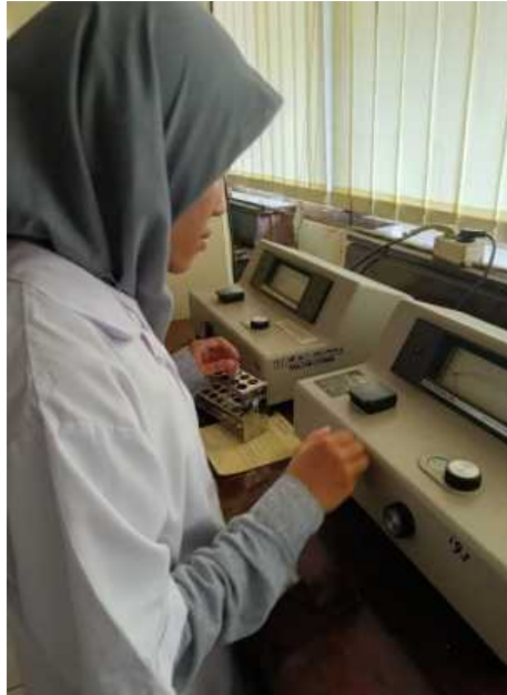
Pengukuran kurva pertumbuhan bakteri menggunakan spektrofotometer
