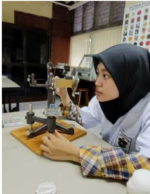
Pengukuran tegangan permukaan menggunakan Tensiometer Du Nouy
