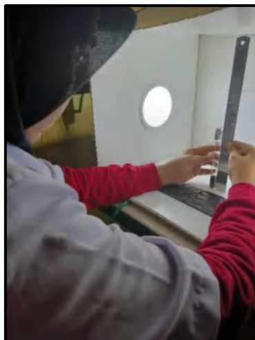
Campuran kultur dan petroleum dihomogenkan dengan sentrifuge, dan diukur indeks emulsifikasinya setelah 1x24 jam
