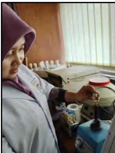
Campuran kultur dan petroleum dihomogenkan dengan sentrifuge, dan diukur indeks emulsifikasinya setelah 1x24 jam
