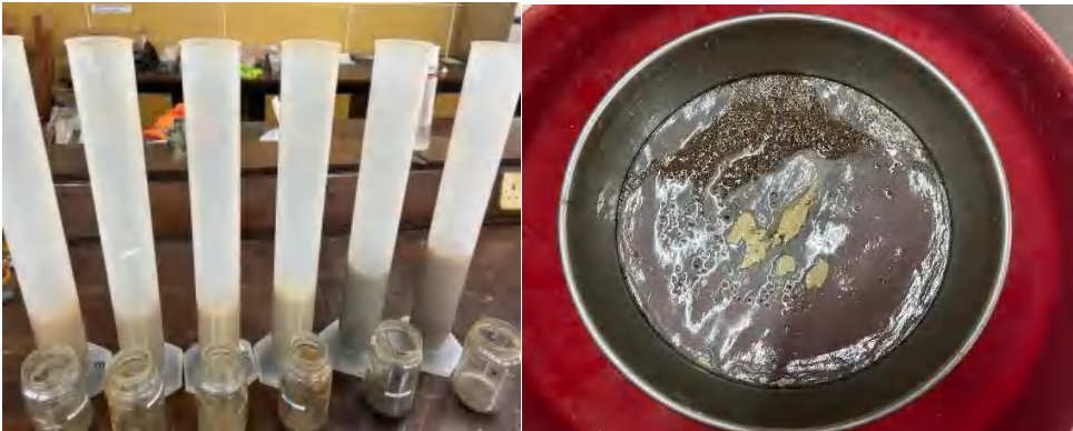
Gambar 11. Analisis Tekstur Sedimen di Laboratorium Kimia dan Kesuburan Tanah
