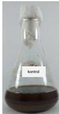
Kontrol (Tanpa Penambahan Isolat Bakteri)
