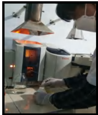
Pengukuran Kadar Besi Menggunakan Atomic Absorption Spectrofotometry
