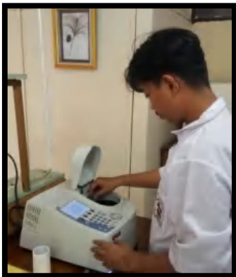
Pengukuran Kadar Besi Menggunakan Spektrofotometer UV-Vis
