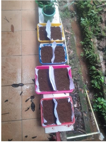
Proses pengeringan dan penghalusan sampel tanah
