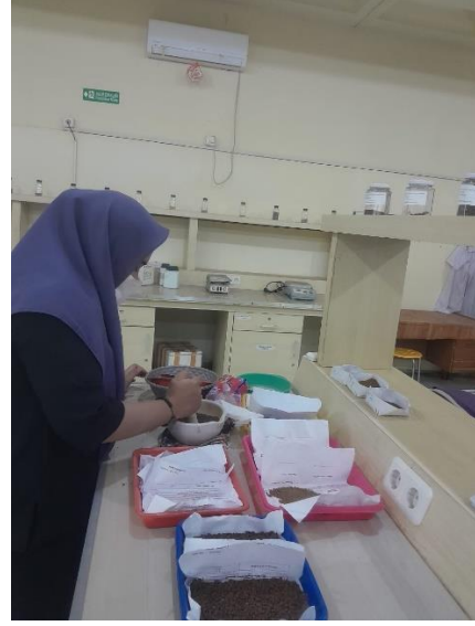
Proses pengeringan dan penghalusan sampel tanah
