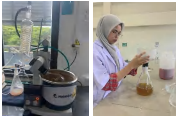
Gambar 2. Penyaringan Larutan Simplisia Dan Proses Maserasi Ekstrak Pelepah Serai Wangi Cymbopogon Nardus L. Menggunakan Rotary Evaporator
