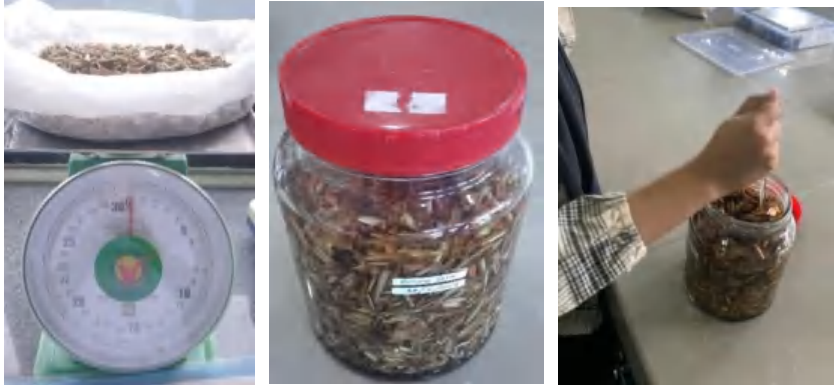
Gambar 1. Simplisia Kering Yang Telah Ditimbang Dan Direndam Larutan Etanol 96%
