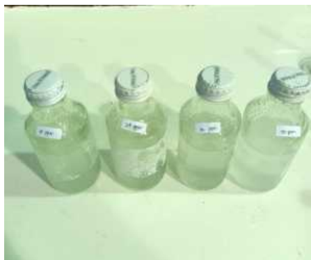
Pembuatan larutan inhibitor 10, 20, 30, dan 40 ppm
