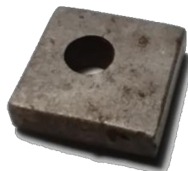
Baja karbon hasil perendaman dengan larutan inhibitor 30 ppm
