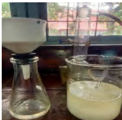
Proses penyaringan dari penambahan HCl 5 M
