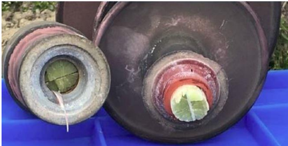
Gambar 3. Kerusakan batang inti isolator polimer
