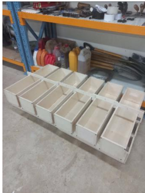
Cetakan balok yang sudah selesai
