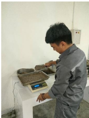
Penimbangan agregat untuk pemeriksaan bahan
