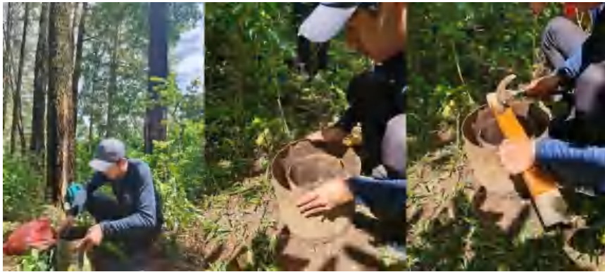
Gambar Lampiran 2. Pemasangan Double Ring Infiltrometer
