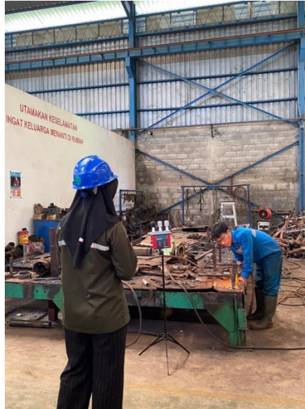
Gambar 1. Pengukuran Iklim Kerja di Bengkel Pipa
