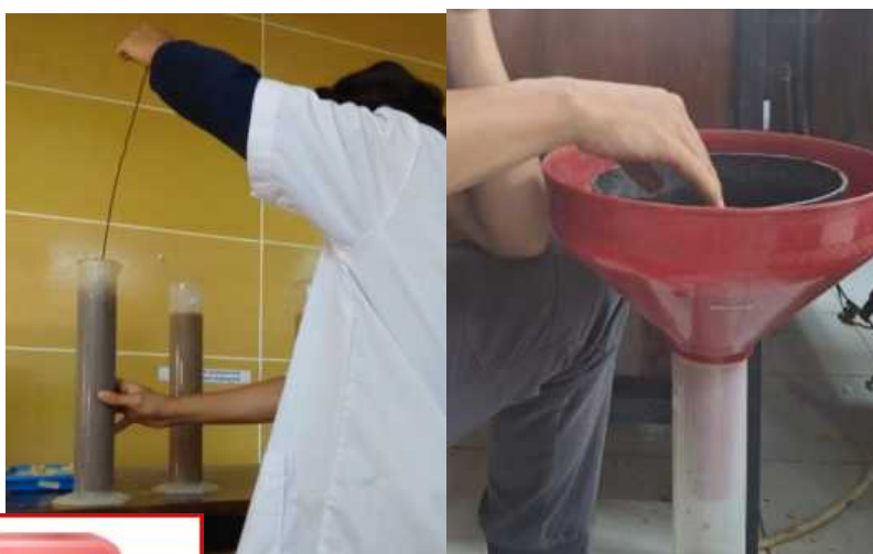
Lampiran 3. identifikasi tekstur tanah dengan metode hidrometer
