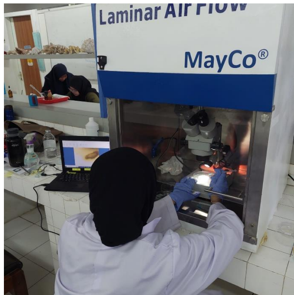
Gambar 20. Proses pengamatan karakteristik serta perhitungan jumlah mikroplastik
