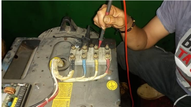
Gambar 4. Proses Megger Test
