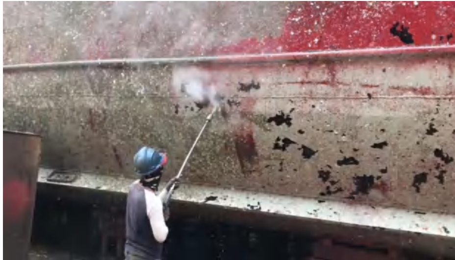
Gambar 2. Proses pembersihan lambung kapal: penyemprotan air tawar bertekanan tinggi
