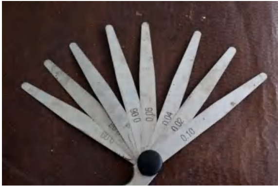
Gambar 12. Peralatan dalam mengukur kelonggaran poros: filler gauge (kiri) dan caliper gauge (kanan)
