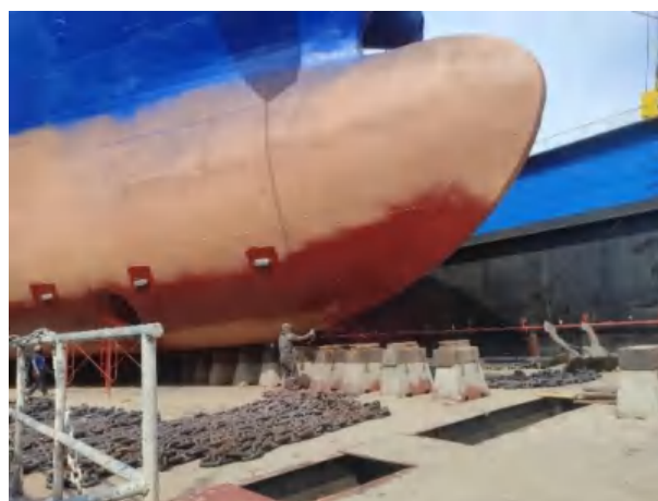
ar 8. Proses pengecatan cat primer lambung kapal menggunakan spray gun
