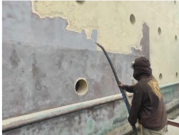
Gambar 3. Sandblasting pada lambung kapal sebagai salah satu proses pembersihan lambung kapal
