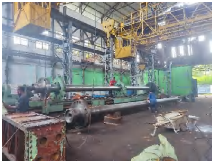
Gambar 13. Proses pelurusan poros propeller yang mengalami pembengkokan
