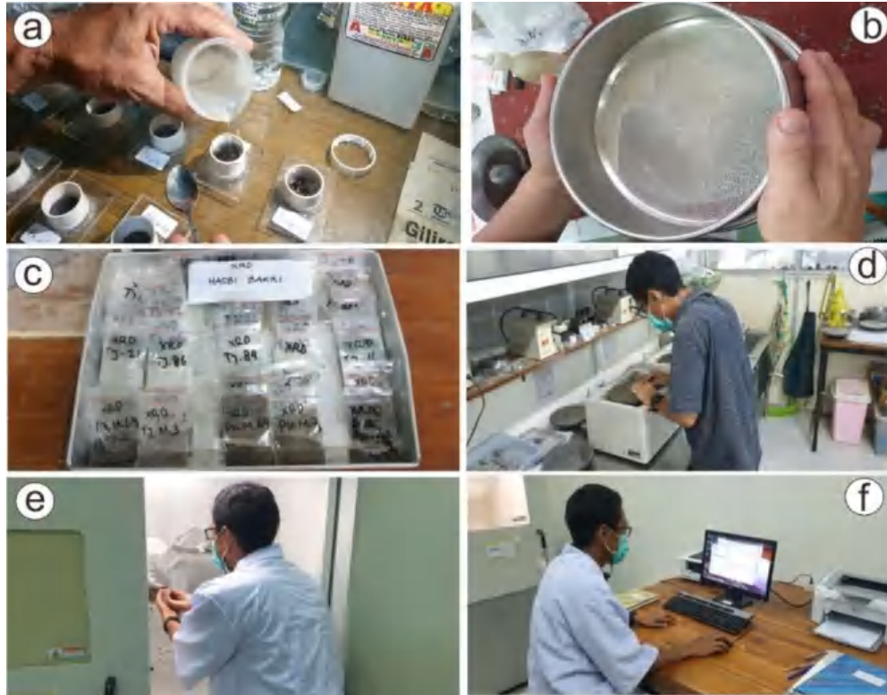
Gambar 2.6 Foto penyiapan sampel dengan menggunakan resin sebelum dimasukkan ke ruang vacuum (a), proses pengayakan hingga 200 mesh (b), sampel yang telah dihaluskan (c), penggerusan sampel batuan uuntuk analisis petrografi dan mineragrafi untuk dianalisis XRD (d), proses memasukkan sampel kedalam alat XRD untuk proses analisis (e), dan (f) identifikasi mineral dengan XRD.
