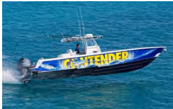
Gambar 4 Kapal dengan stepped hull
