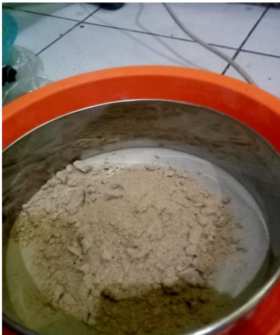
Penyaringan serbuk bekatul dan lawi-lawi dengan penyaringan 70 mesh Hingga menjadi tepung
