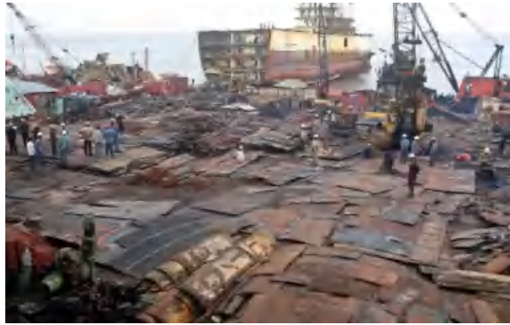
Gambar 5 Kegiatan Metal Cutting kapal
