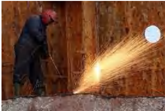
Gambar 4 Gambar Pemotongan kapal bekas
