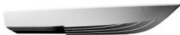
Gambar 6 Kapal dengan Lambung Bertangga
