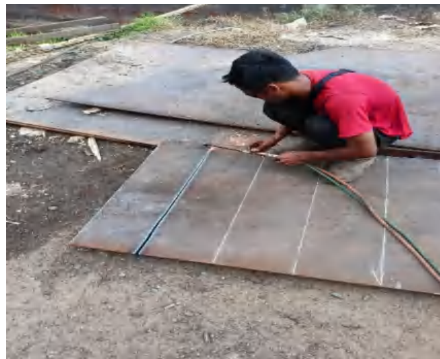
Gambar 1 Pemotongan menggunakan gas oxy Sumber : dokumentasi pribadi
