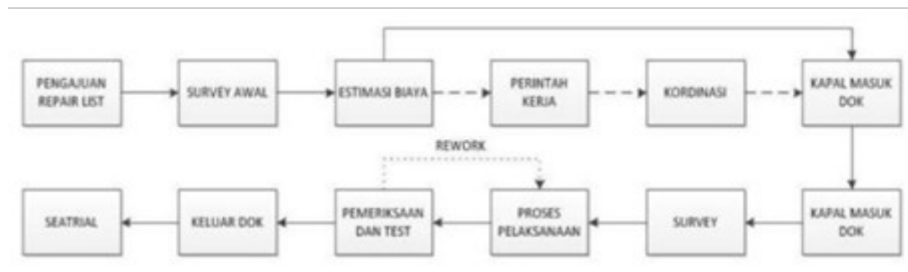
Gambar 1 Tahapan Reparasi Kapal
