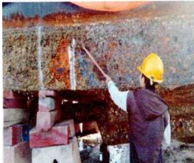
Gambar 3 Penyekrapan Lambung Kapal
