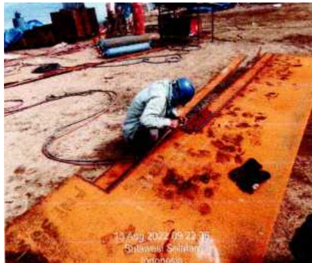
Gambar 13 Proses Cutting Plat Untuk Bilga Keel
