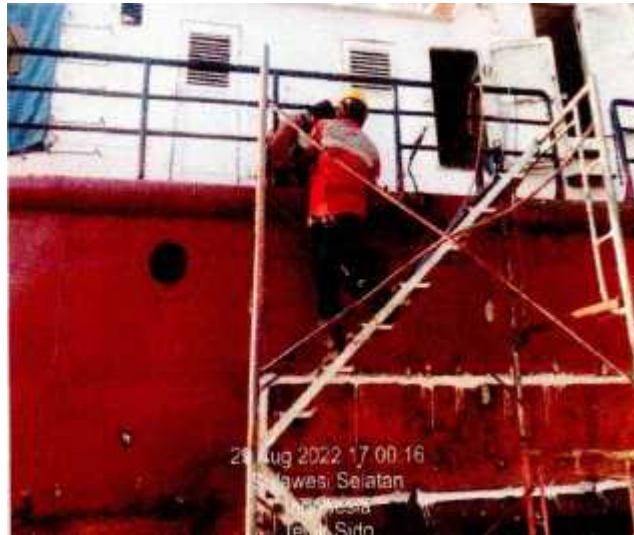
Gambar 16 Penggantian Tiang Railing dan Fender
