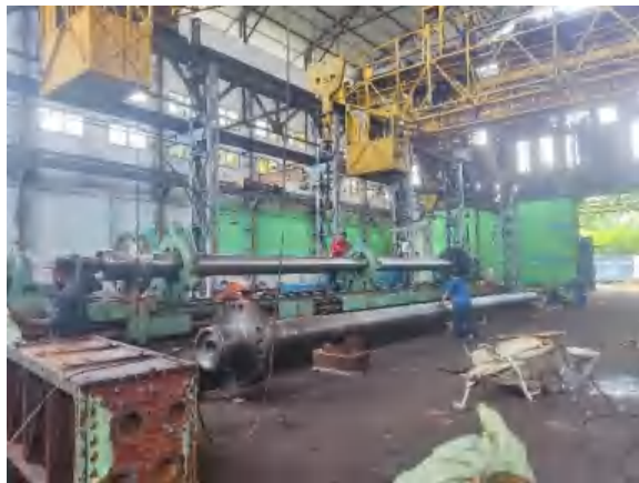
Gambar 7. Proses perbaikan poros propeller
