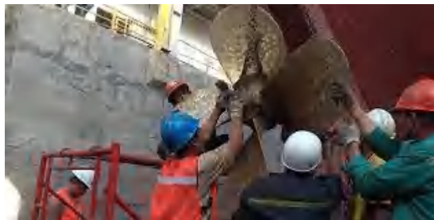
Gambar 6. Perawatan propeller kapal
