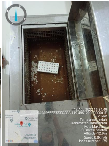
(h). Water bath sampel selama 60 menit dengan suhu 63 0 C
