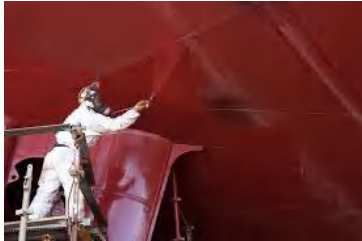
Pengecatan badan kapal
