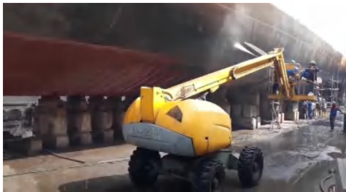
Pencucian air tawar lambung kapal
