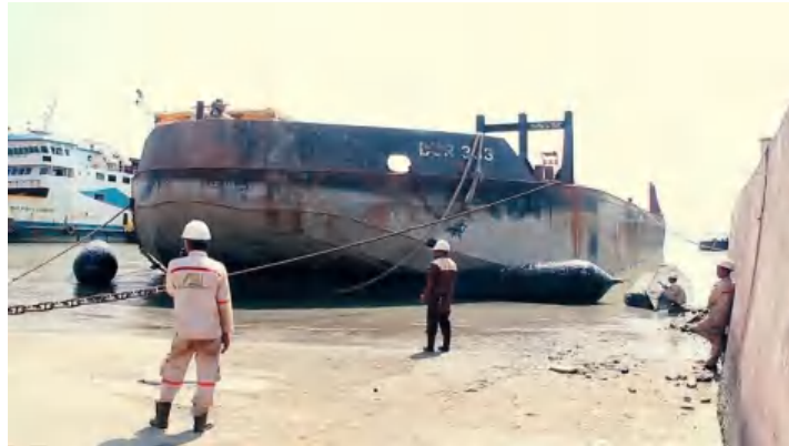
Proses docking kapal menggunakan airbag
