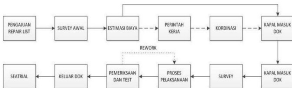
Gambar 1 Proses pengerjaan kapal
