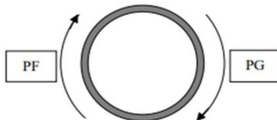
Gambar 4 Kode ISO posisi las pipa (sumber: 2008)
