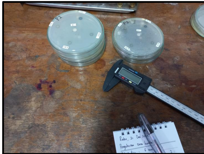
Gambar 12. Pengukuran diameter zona hambat
