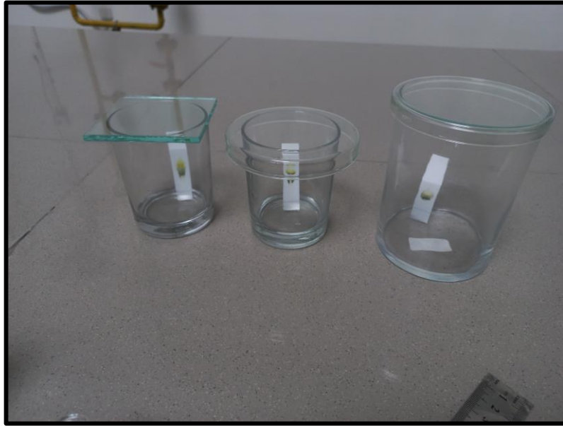
Gambar 13. Proses Elusi dalam Chamber dengan fase eluen campuran
