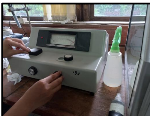
Gambar 9. Pengukuran kekeruhan hasil uji dilusi cair dengan Spektrofotometer UV-Vis
