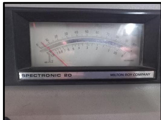
Gambar 9. Pengukuran kekeruhan hasil uji dilusi cair dengan Spektrofotometer UV-Vis
