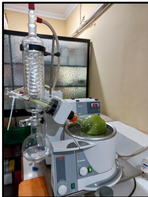
Gambar 3. Rotary Evaporator digunakan untuk memisahkan ekstrak dari pelarut
