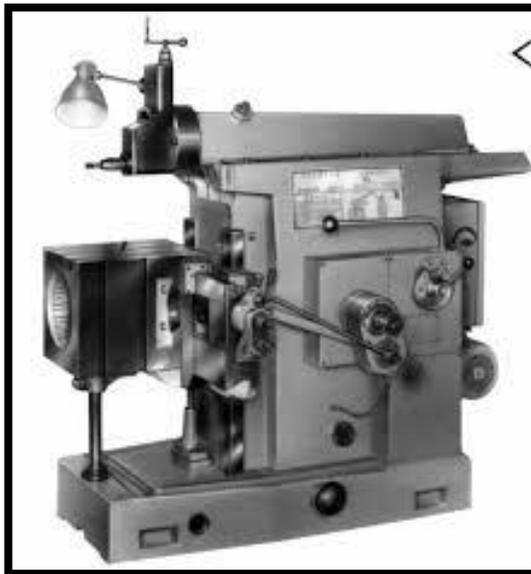
**Gambar 2.5** Mesin sekrap horizontal (*shaper*)
