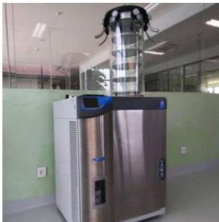
Pengeringan menggunakan freeze dry
