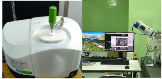
Karakterisasi Hidrogel dengan FTIR dan analisis morfologi menggunakan SEM
