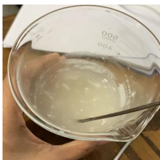
Sintesis CMSS dengan pati sagu dan SMCA
