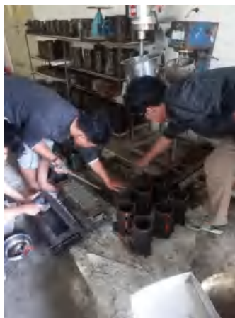
(b) Pencetakan Beton
