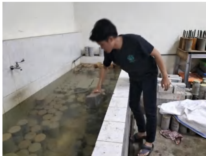
(b) Peletakan Benda Uji ke dalam Bak Curing
