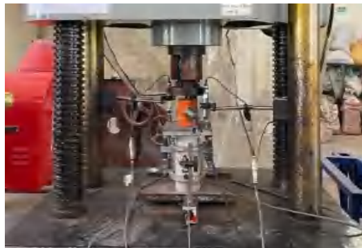
(b) Pengujian Kekuatan Tekan Beton
