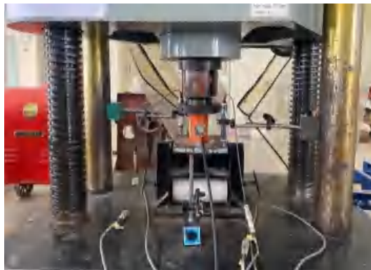
(c) Pengujian Kekuatan Tarik Belah Beton
