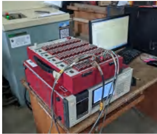
(a) Data Logger dan Komputer untuk Merekam Hasil Pengujian
