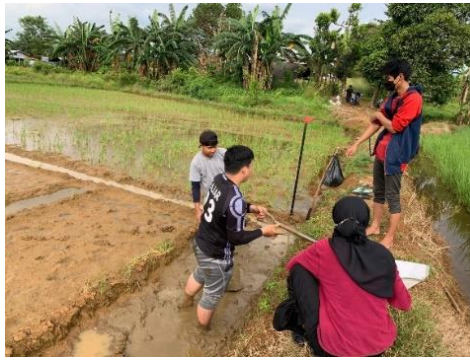
Gambar Lampiran 27. Proses pengambilan sampel tanah
