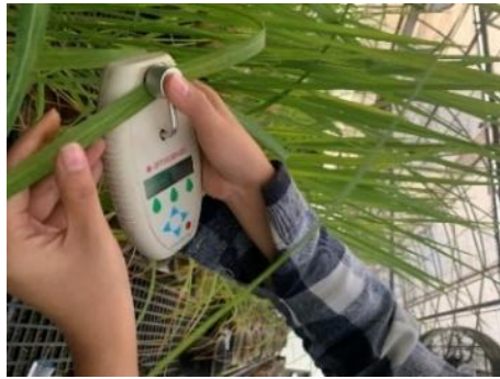
Gambar Lampiran 35. Pengukuran klorofil daun padi menggunakan CCM 200+
