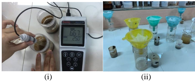
Gambar Lampiran 41. Proses analisis pH (i), analisis tekstur tanah (ii)
