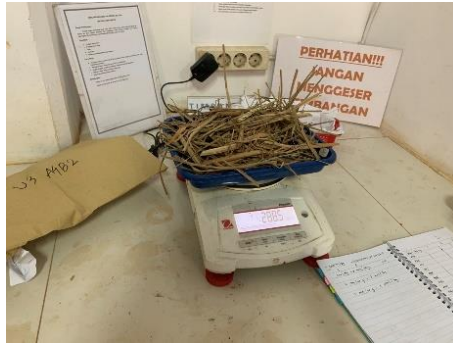
Gambar Lampiran 39. Proses pengukuran berat kering tajuk padi setelah dilakukan pengovenan
